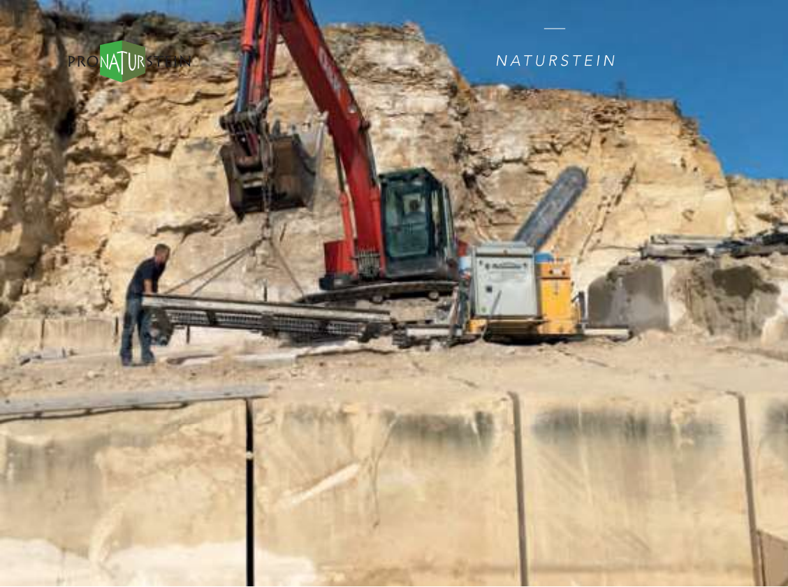
Ressourcenschonender Abbau: Das Rohmaterial wird mit der Schrägmsäge gewonnen.
